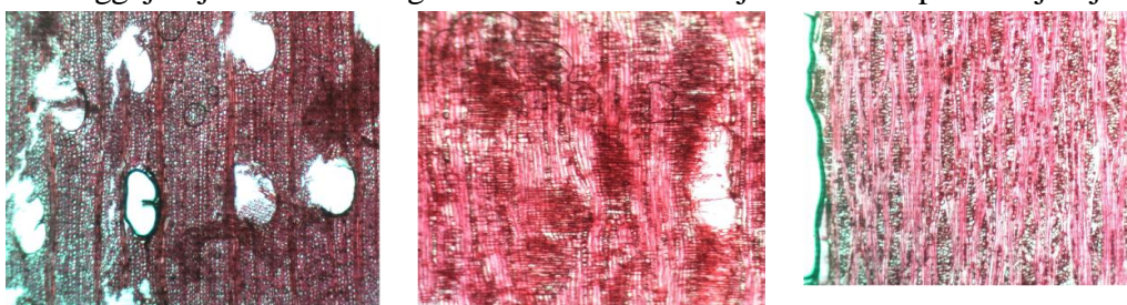
Gambar 3. Struktur mikrotom kayu durian bidang transversal (kiri), radial (tengah), dan tangensial (kanan).
