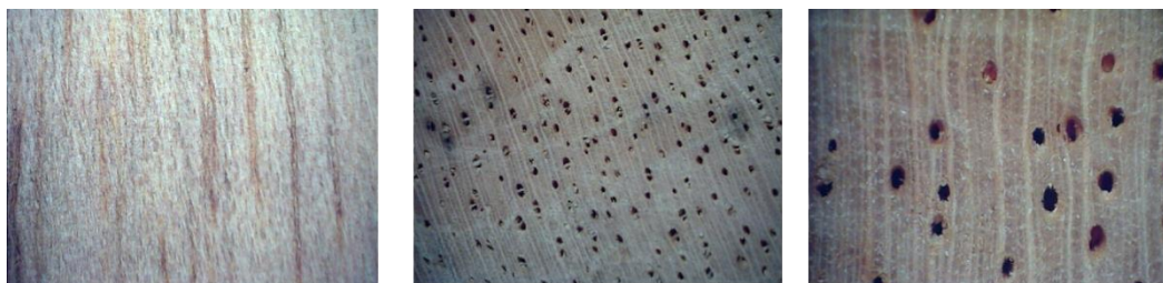
Gambar 2 Struktur Makroskopis kayu durian, tekstur bidang tangensial (kiri), bidang transversal perbesaran 10x (tengah), bidang transversal perbesaran 30x (kanan) .
